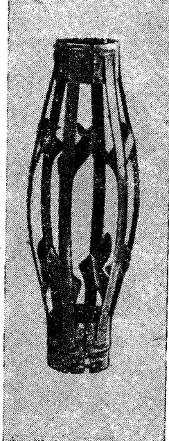
раствором. Полнота вытеснения промывочной жидкости зависит прежде всего от режима течения промывочного и цементного растворов. При эксцентричном расположении колонны в скважине добиться турбулизации потока цементного раствора во всех точках поперечного сечения заколонного пространства практически невозможно. Поэтому при спуске обсадных колонн применяют центраторы.
